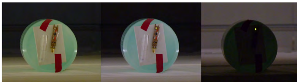
Abbildung 3.58: Schaltung mit Spule und Leuchtdiode im MRT auf Phantom (links: nicht angeregt, Mitte und rechts: angeregt)
