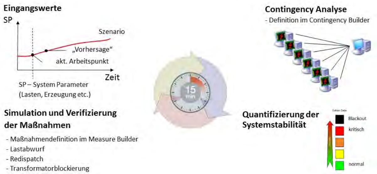
Abbildung 3.26: Prinzip der dynamischen Netzsicherheitsberechnung
