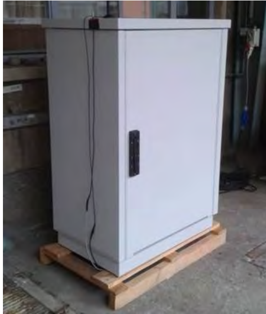
Abbildung 3.27: BZ-USV auf dem Außengelände der OvGU zur Überprüfung des Temperaturverhaltens im Anlageninneren
